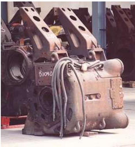
I motori sono in numero di sei, uno per asse: le loro carcasse (foto qui sopra), ancorate rigidamente al telaio dei carrelli, si distinguono in destre e sinistre a motivo del fatto che vi sono gli ingranaggi di trasmissione del moto posti tutti da un lato.
